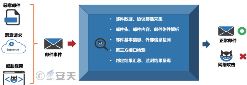
图 4-1 安天邮件安全监测服务示意图
